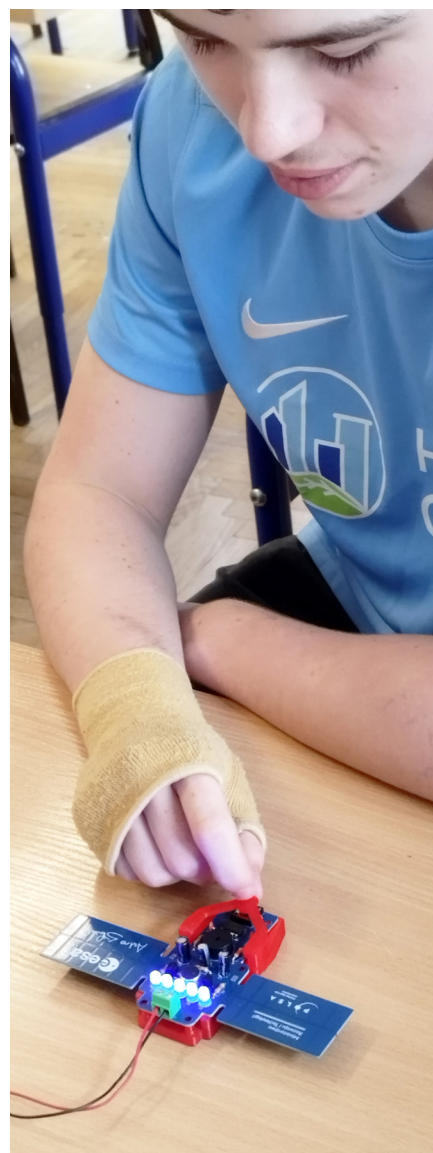
Fotografia 9. Uczeń Gutek Szwed podczas testowania zestawu edukacyjnego „Klucz do Kosmosu”. Naciśnięcie przycisku S1 powoduje generowanie sygnałów alfabetu Morse’a
